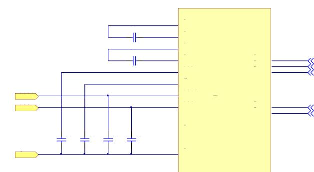
Recommended components : C1, C2 : 2.2uF C3, C4 : 1.0uF C5, C6 : 1.0uF/10V
